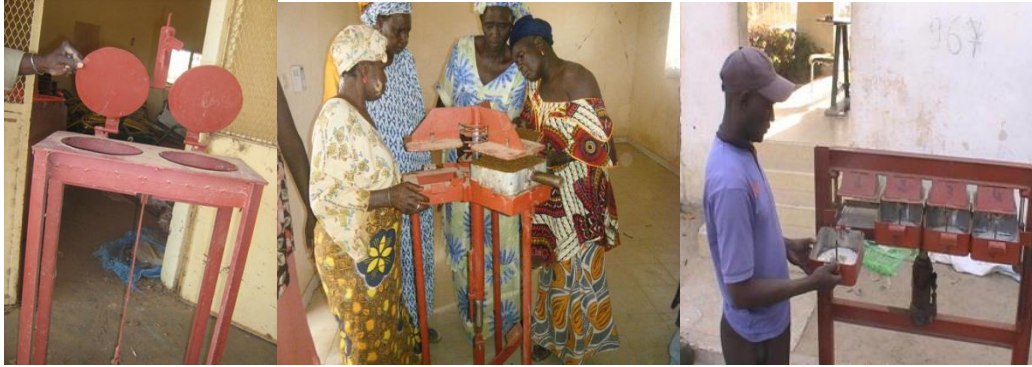
Figure3 : (i) La machine CRZ Dahra conçue en 1984, (ii) la machine trimoule à pédale CRA Saint-Louis conçue en 2011, (iii) la machine quadrimoule à pression hydraulique de 2012 CRA/SL et (iv) Une démonstration de Femmes de Walo Aliment de Richard Toll à leurs homologues (éleveurs, fabricants aliments, transformateurs laitiers du département de Linguère en visite de travail (photos : Cheikh Sall)
